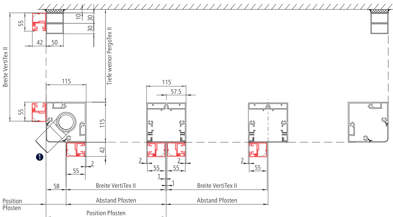
Draufsicht von drei VertiTex II Schienenführungs-Anlagen am Pfosten Mitte der weinor PergoTex II mit Ablauf
