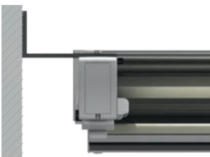
Befestigung der weinor PergoTex II Basic in einer Nische bzw. seitlich an einer Wand mit dem Befestigungswinkel 200 x 100 x 10 x 120 mm
