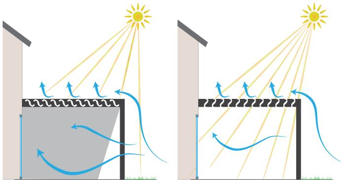
Pergola IZI Schützt Sie vor UV-Strahlen und ermöglicht die Luftzirkulation.
